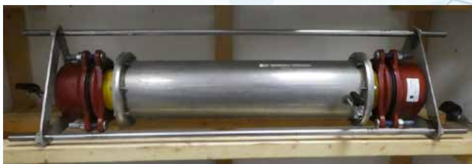
شکل ۱. لوله PVC آب‌بندی شده که برای اندازه‌گیری نفوذپذیری، درون یک لوله پوششی فولادی قرار گرفته است.
