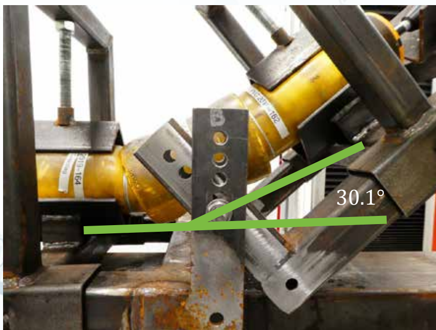
شکل ۳. حداکثر زاویه انحرافی که دستگاه آزمایش به آن رسید. هیچ نشأت اتفاق نیفتاد.
