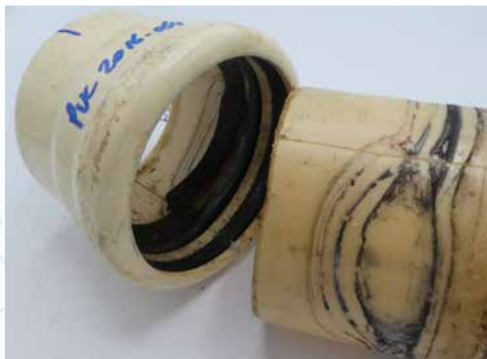
شکل ۴: اتصال PVC 2016-064 پس از انجام آزمایش و باز کردن قطعات
